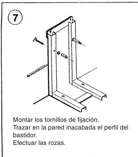
Montar los tornillos de fijación. Trazar en la pared inacabada el perfil del bastidor. Efectuar las rozas.
