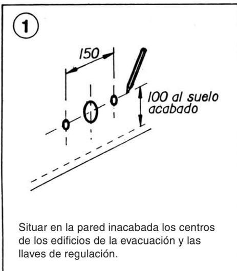
Situar en la pared inacabada los centros de los edificios de la evacuación y las llaves de regulación.
