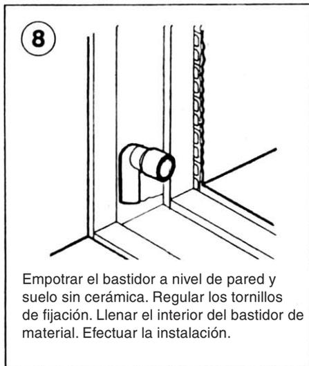
Empotrar el bastidor a nivel de pared y suelo sin cerámica. Regular los tornillos de fijación. Llenar el interior del bastidor de material. Efectuar la instalación.
