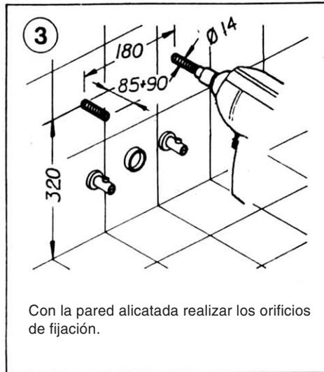
Con la pared alicatada realizar los orificios de fijación.
