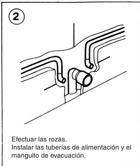
Efectuar las rozas. Instalar las tuberías de alimentación y el manguito de evacuación.
